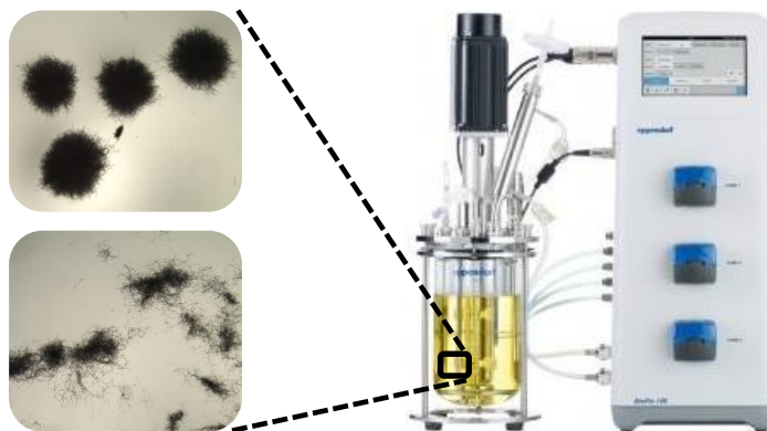
Fermentereinheit im Labormaßstab (r.) und A. niger in pelletförmiger (l. o.) und myzeliger Form (l.u.)
