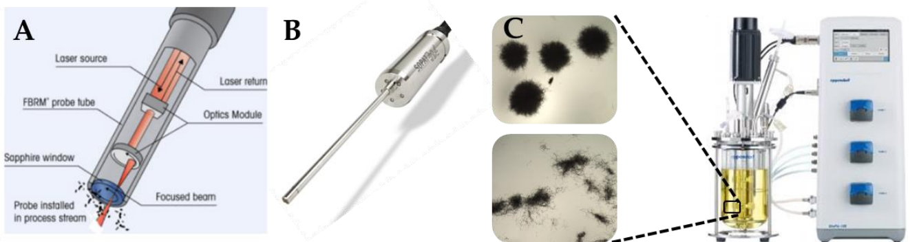
Abbildung 1 Messprinzip der FBRM-Sonde (A); Sopat-Sonde zur fotooptischen Partikelgrößenbestimmung (B); Bioreaktor (rechts) und A. niger mit unterschiedlicher Wachstumsform (links)
