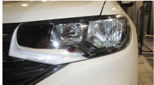
Abbildung 1 Tropfenkondensation an der Abdeckscheibe im Frontscheinwerfer (Bild: Volkswagen AG)
